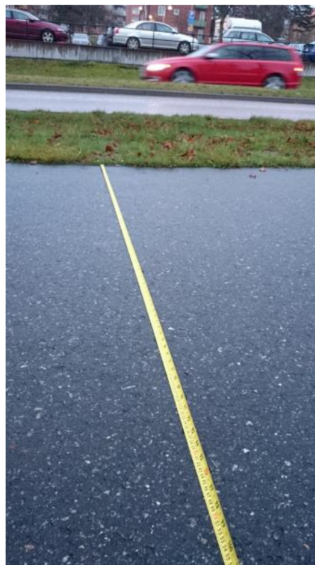
Figur 1-1. Mätning av gångbaneläbredd.
