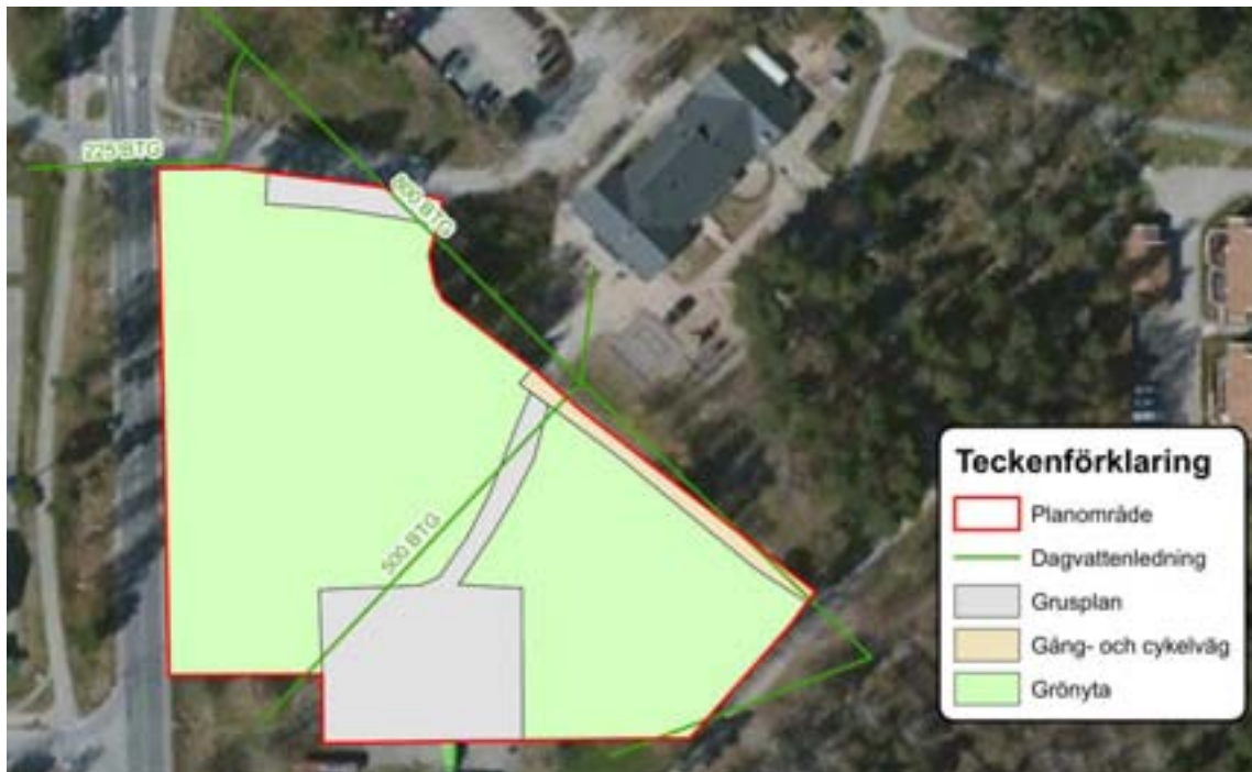
Figur 6. Befintliga dagvattenledningar i anslutning till detalplaneområdet. Bakgrundsbild från ESRI.
