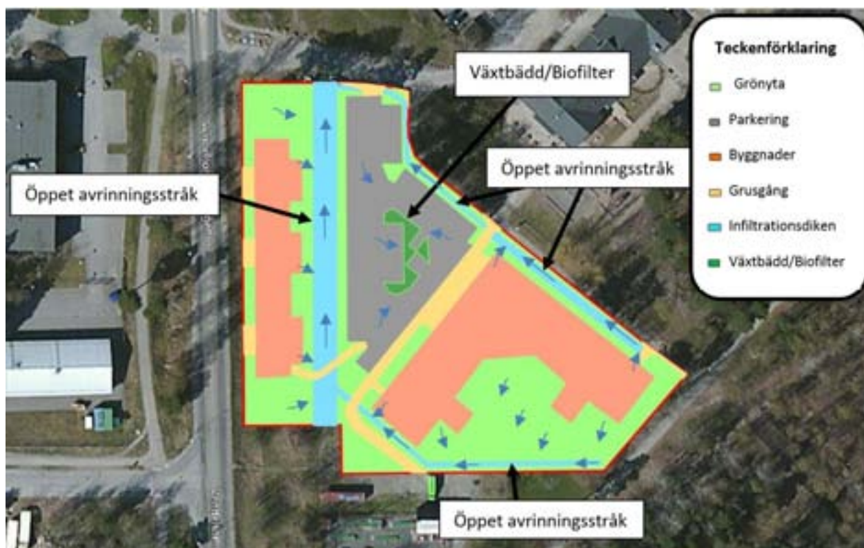
Figur 23. Översiktlig skiss för möjliga placeringar av föreslagna lösningar i form två mindre öppna avrinningsstråk som nedströms ansluter till ett större öppet avrinningsstråk samt en regnbädd med biofilter i mitten av den planerade parkeringen. Bildkälla bakgrundsbild: Bing 2017.
