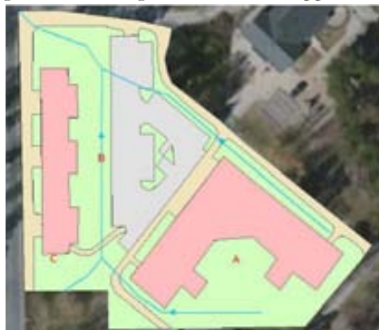
Schematisk höjdsättning av avrinningsstråk (Dagnatten-utredning - Söderby 2:27 och Söderby huvudgård 4:315, 2017-03-07, WSP)
