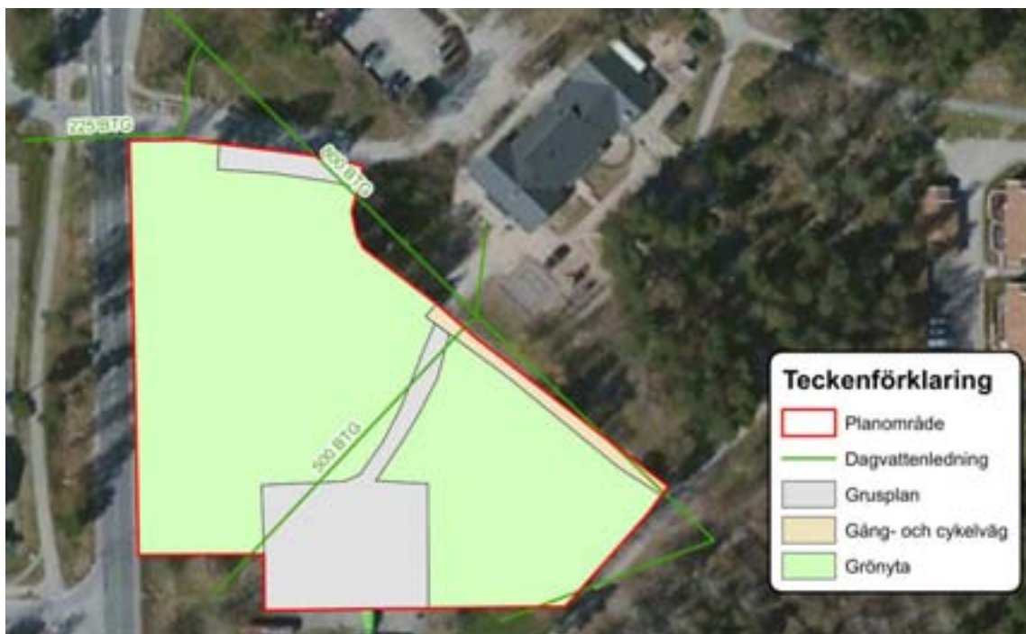
Figur 8. Befintliga dagvattenledningar i anslutning till detaljplaneområdet. Bakgrundsbild från ESRI.
