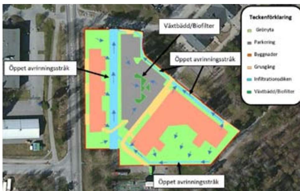
Översiktlig skiss för möjliga placeringar av föreslagna dagvattenlösningar i form av två mindre öppna avrinningsstråk som nedströms ansluter till ett större öppet avrinningsstråk, samt möjlig placering för biofilter (Dagvattenutredning - Söderby 2:27 och Söderby huvudgård 4:315, 2017-03-07, WSP)
