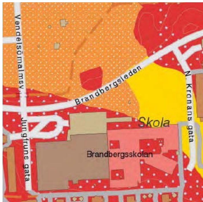
Bild 14: Gult lager visar glacial lera, orange med vita prickar visar postglacial sand och rött med blå prickar visar morän på berghäll.
