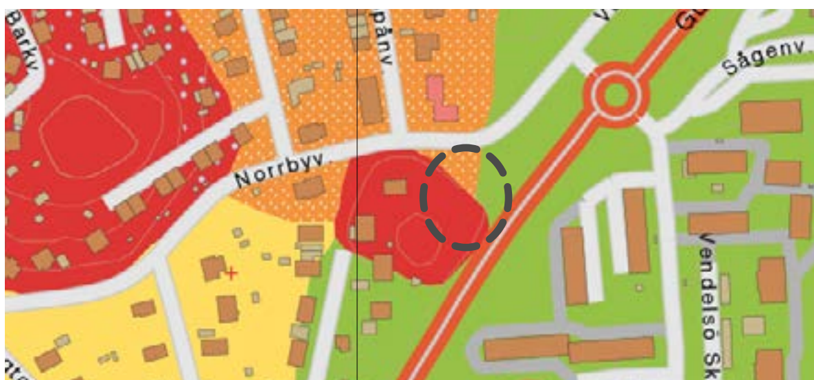
Utdrag ur SGU:s jordartskarta. Rött område är urberg, grönt område är isälvssediment, orange område med vita prickar består av postglacial finsand och gult område består av postglacial lera. Planområdet är ungefärligt markerat med svart streckad linje.
