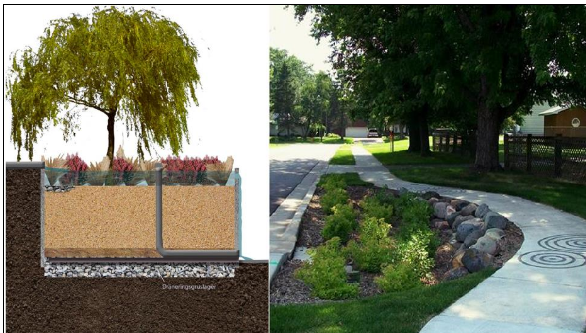
Figur 7-3. Illustration av hur en regnbädd kan byggas upp som upphöjd (till vänster) eller nedsänkt (till höger) (Illustration Åsa Wellander och foto från City of Maplewood).
