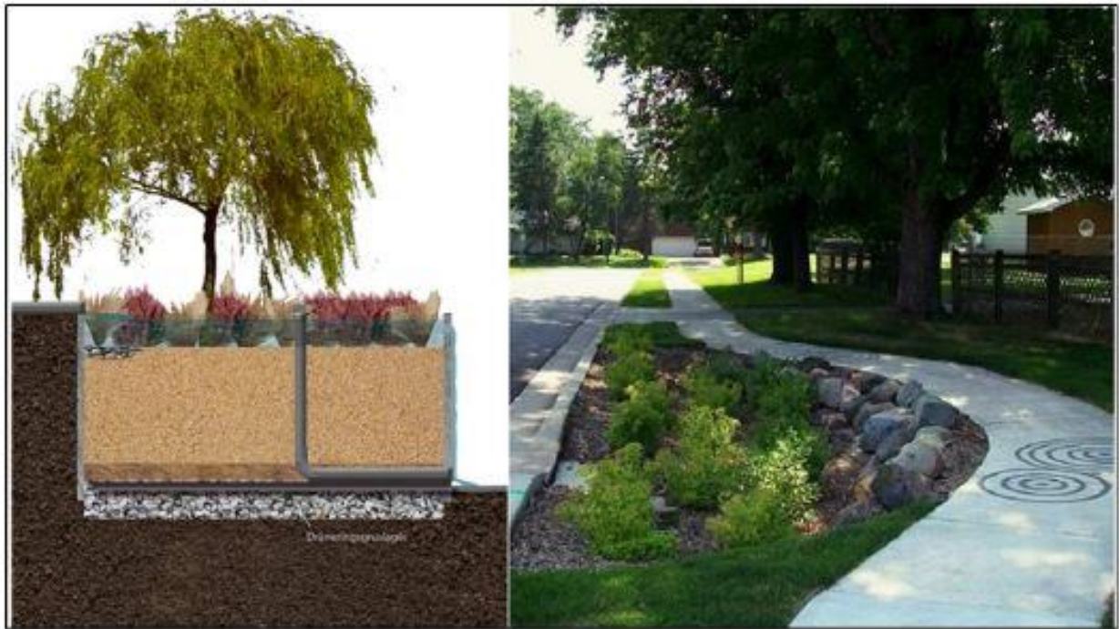
Figur 19. Illustration av hur en växtbädd kan byggas upp som upphöjd (till vänster) eller nedsänkt (till höger) (Illustration Asa Wellander och foto från City of Maplewood).
