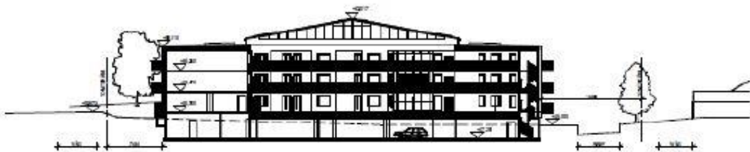
Figur 17. Förslag för planerade hus. Husen byggs med lägenheter i tre plan och källare med garage. Sektion ifrån Vardövägen av Liljewall 2018-08-30.
