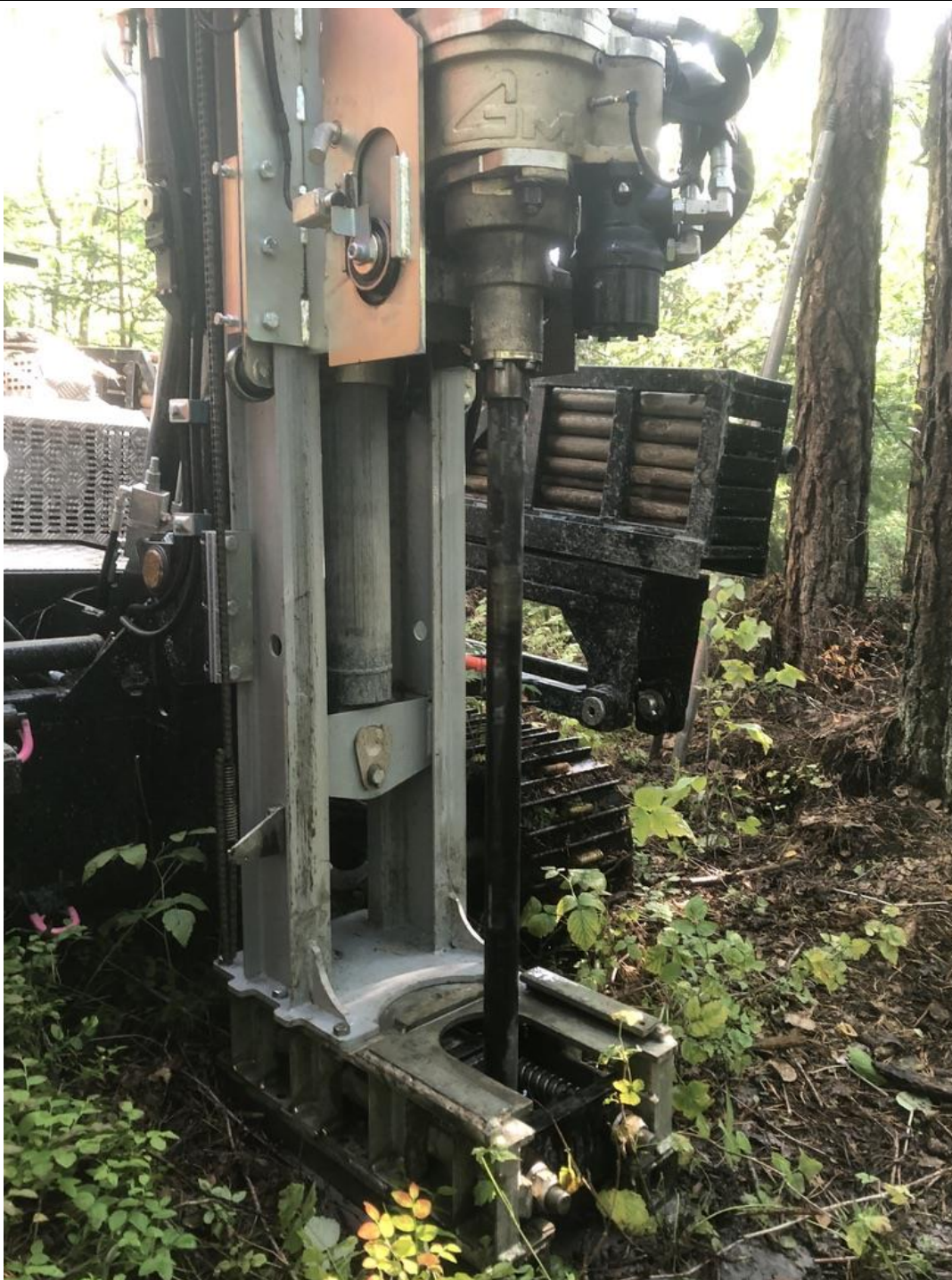
Figur 2. Pågående jord/berg-sondering. Bild av Geoveta, 2018-08-29.
