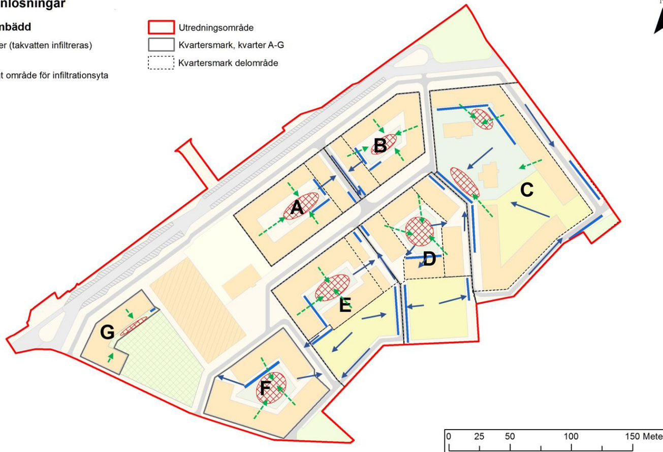
Figur 7:3 Skiss över dagvattenlösningar inom kvarter under förutsättning takvatten kan infiltreras. Fördröjningsytor har fördelats för att ta hand om vatten inom olika delområden inom varje kvarter. Gröna streckade pilar avser avrinningsriktningar för takvatten, blå pilar avrinningsriktningar för övrigt dagvatten inom kvarter.
