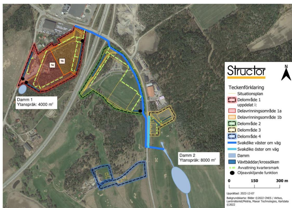
Figur 6-12. Föreslagna dagvattenlösningar (Structor, 2023).
