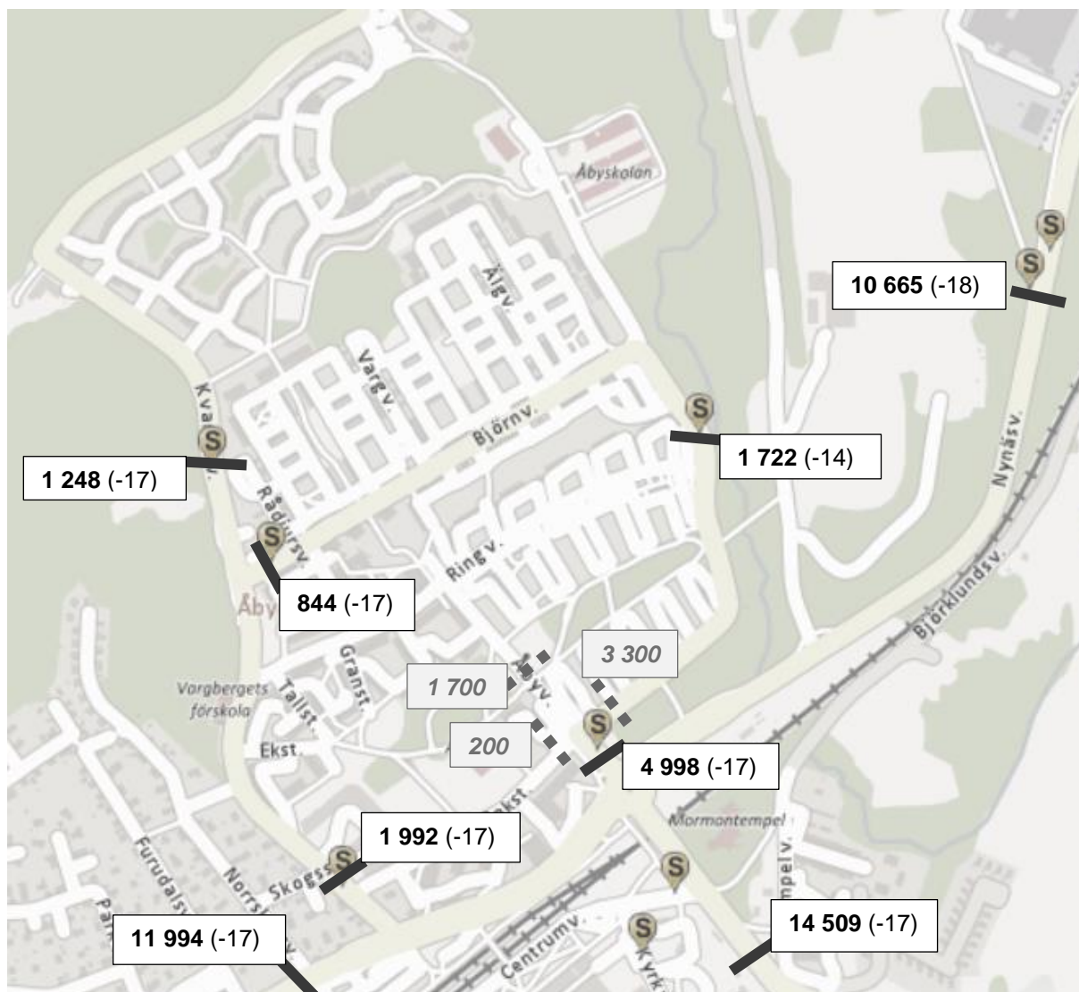
Figur 2: Dagens trafik i antal fordon per vardagsdygn. Uppmätt trafik i nuläget (åtta svarta heldragna snitt med mätår inom parentes), samt bedömd trafik i nuläget (tre gråa streckade snitt).
