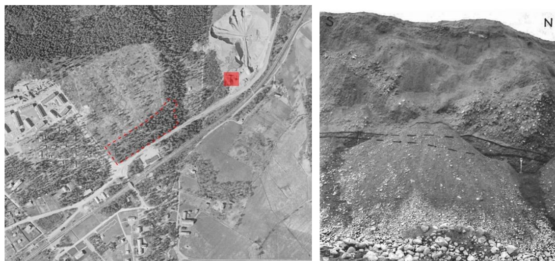
Figur 4. Bilden till vänster; flygfoto från slutet på 1950 eller början på 1960-talet innan området exploaterades. Bilden till höger redovisar skärning (ungefär i läget för den röda rutan i bilden till vänster) i tidigare, närliggande grustäkt, där moränlagrets övre och undre gräns är markerat.
