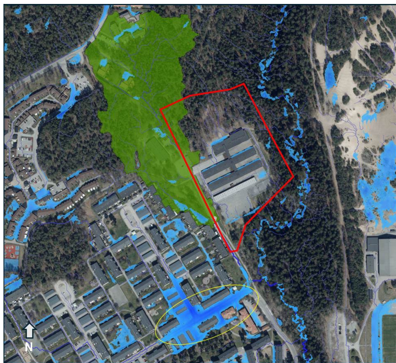
Figur 24. lågpunkt i söder markerad med gul ellips. Vid yttlig avrinning är det främst vatten från avrinningsområde 2 (grönt fält) som rinner till lågpunkten. Bild från dagvattenutredningen (Funkia, 2024).
