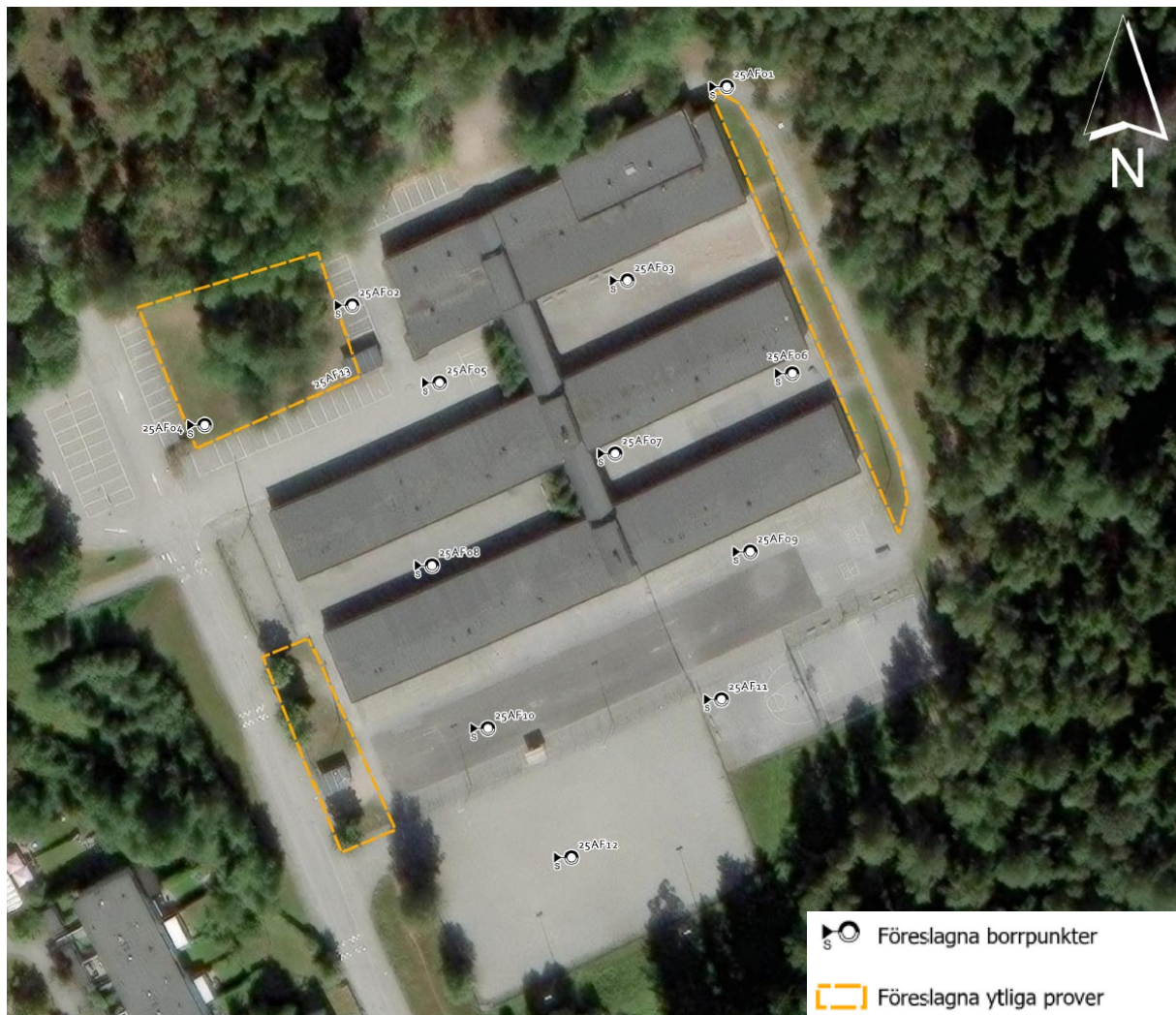
Figur 16 visar provtagningskartan. PCB har påvisats i halter över riktvärdena för känslig markanvändning (KM) i två provpunkter, 25AF07 och 25AF09. I övrigt förekommer halter över KM i två andra provtagningsytor, 25AF13 och 25AF15. Krom har påträffats i halter över KM i provpunkt 25AF02, och alifater i halter över KM i provtagningsyta 25AF13.
