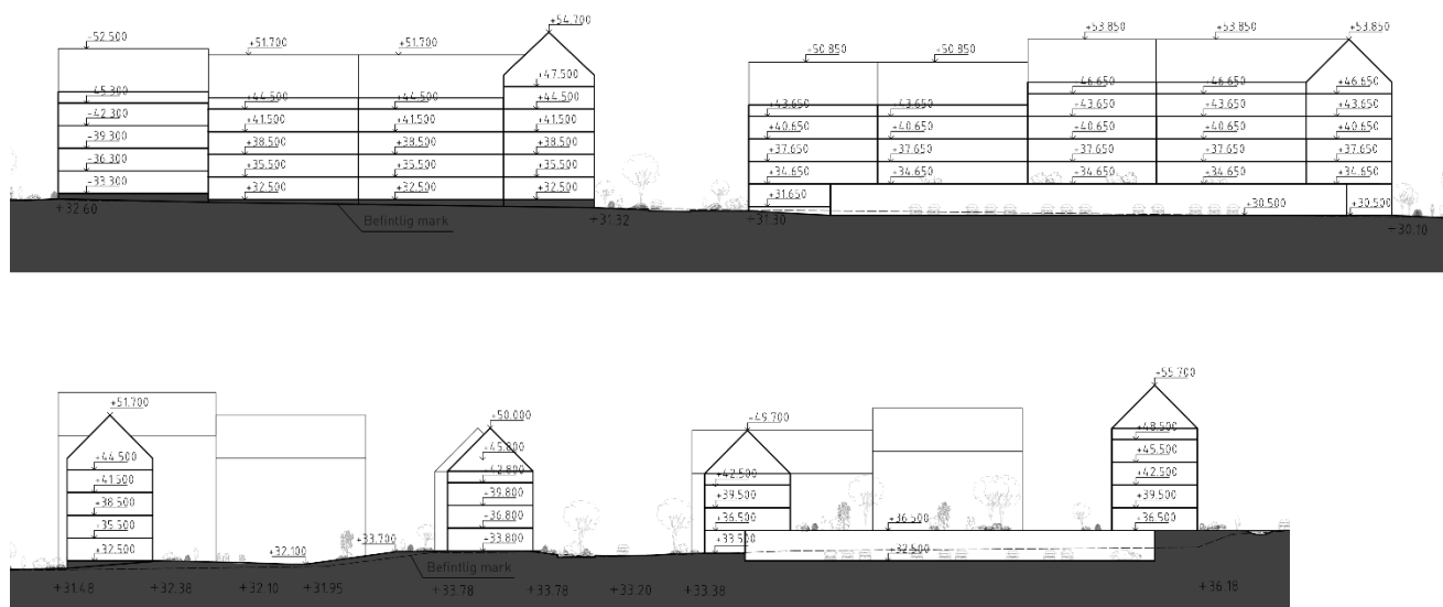
Figur 15. Sektioner A-A (ovan) och B-B (nedan) som illustrerar byggnadernas varierande höjd inom planområdet samt hur parkering är tänkt att anordnas inom kvarteren. Se även sektionslinjer i figur 14.
