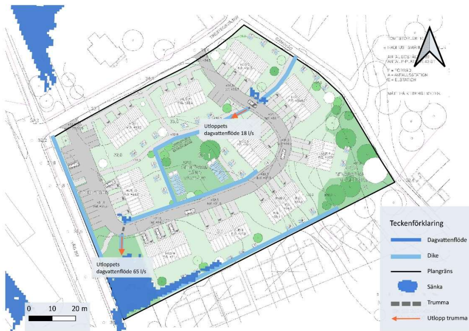
Figur 9-6. Skiss över möjlig placering av två trummor och deras utflöde vid ett 20-årsregn, modellerat med dagvatten för alla delavrinningsområden inom planområdet. Sänka i mörkblått visualiserar vart nederbördens preferens att samlas.
