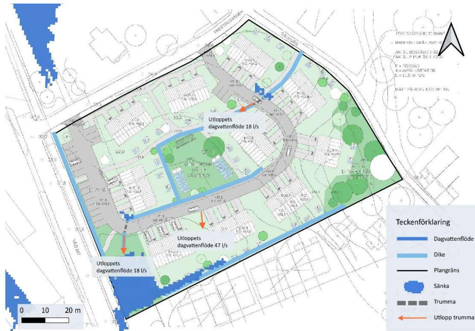
Figur 9-7. Möjlig placering av tre trummor och deras utflöde vid ett 20-årsregn, modellerat med dagvatten för alla delavrinningsområden inom planområdet. Sänka i mörkblått visualiserar vart nederbördens preferens att samlas.
