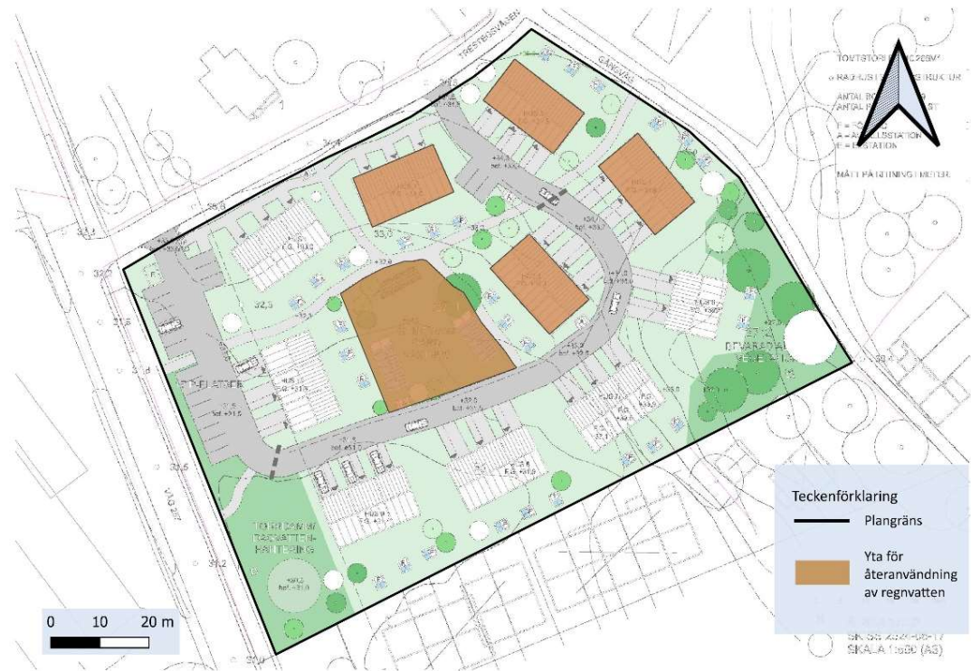
Figur 11-1. Föreslagna ytor för återanvändning av regnvatten.
