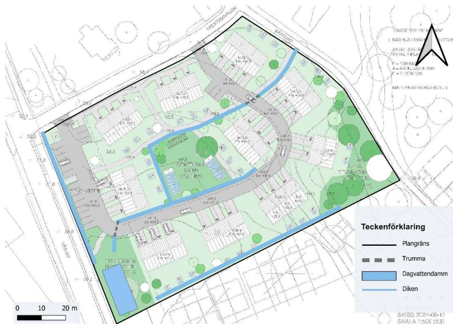
Figur 9-2. Skiss av föreslagen lokalisering av dagvattenåtgärder i planområdet. Detta är inte en exakt utformning eller placering utan en ungefärlig placering.
