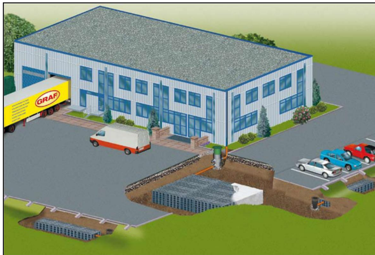
Figur 7:6. Exempel på utjämningsmagasin bestående av dagvattenkassetter (Uponor)
