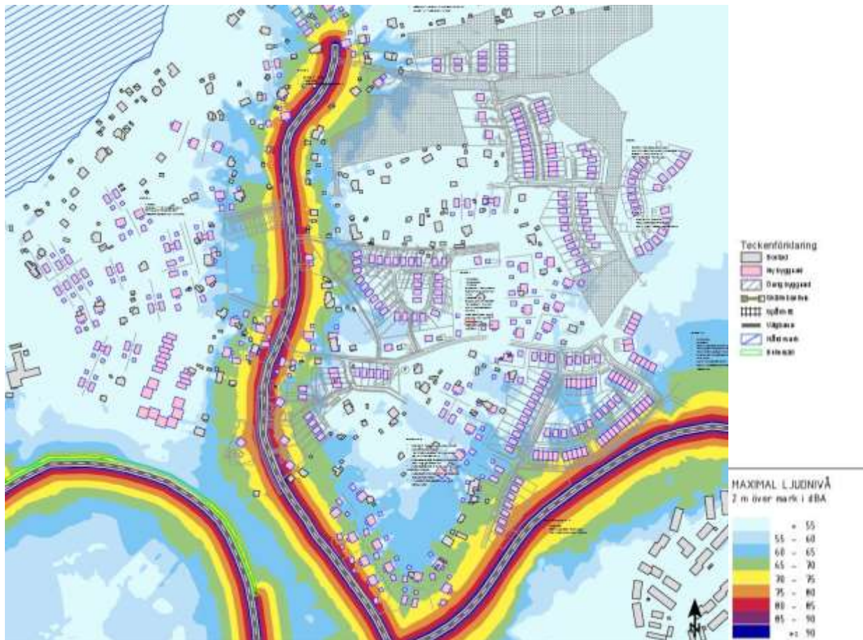
Figur 21. Utdrag ur framtagna bullerutredning (Tyréns 2016) som visar maximala bullernivåer efter utbyggnad och två meter relativt mark.
