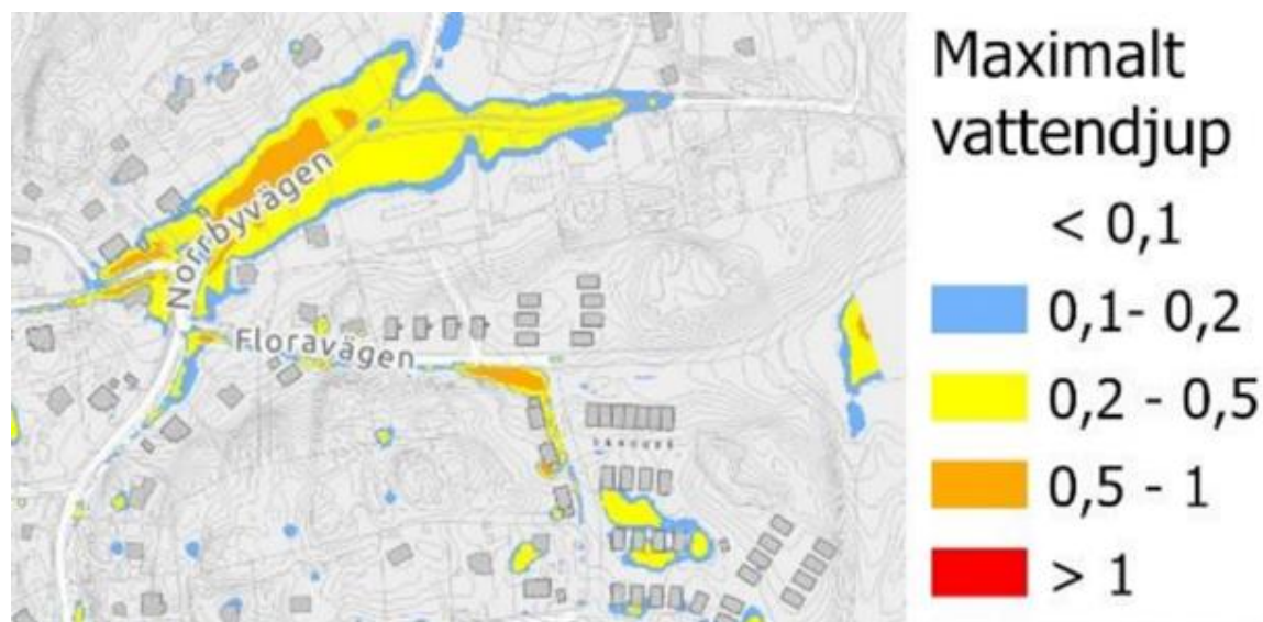
Bild 21. Framtidsscenario - modellerad översvämnings vid ett 100-års regn angivet i meter i norra delen av planområdet (Ramboll, 2022).
