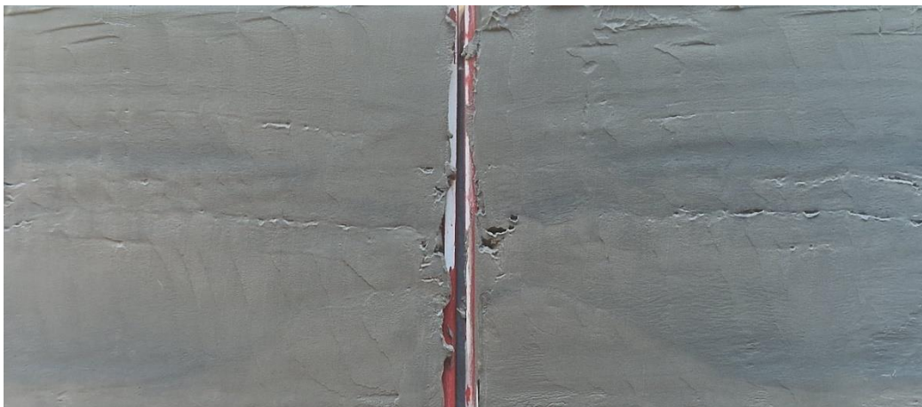
Figur 1 Borrpunkten, 22B01, 3,0 m, Jordprovet i nedre delen av mellanhylsan delad longitudinellt provhylsan med id BAAB 1339.
