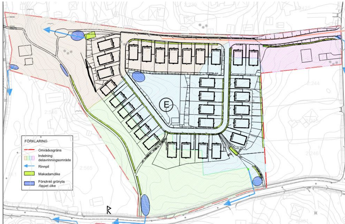
Figur 19. Förslag för hantering av dagvatten inom kvarter E.
