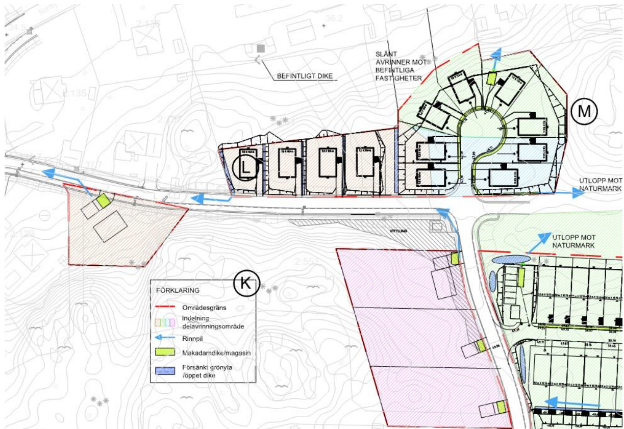
Figur 22 Föreslagen dagvattenhantering för kvarter K, L och M.
