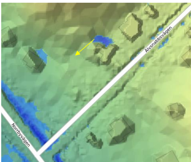
Figur 12. Maximala vattendjup, indikerar en falsk lågpunkt i terrängen. Den gula pilen indikerar vattnets troliga flödesriktning.
