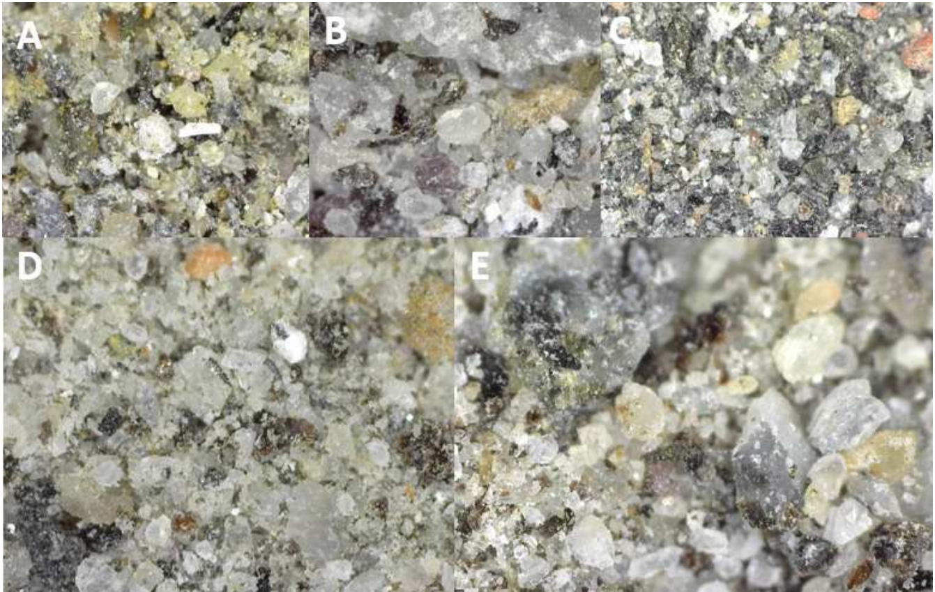
Figur 7. Exempel på mikroskoperade bilder av kaxprover. Digitalt mikroskop Dine Lite Edge. 65x förstoring. A. Prov 21AF021. Tydliga kvartskorn, biotitkorn, plagioklas, granatkorn, inga synliga sulfider, viss rostighet. Sedimentgnejs. B. Prov 21AF023. Tydliga kvartskorn, biotitkorn, även korn av plagioklas. Inga synliga sulfider. Sedimentgnejs. C. Prov 21AF028. Tydliga kvartskorn, biotitkorn, även korn av plagioklas och granat, inga synliga sulfider. Sedimentgnejs. D. Prov 21AF042. Mycket kvartskorn, biotitkorn, fältspatskorn, antagligen ett korn av granat överst i mitten. Inga synliga sulfider. Sedimentgnejs. E. Prov 21AF047. Mycket kvartskorn, mycket små biotitflagor/korn, fältspatskorn, granatkorn, inga direkt synliga sulfider. Sedimentgnejs.
