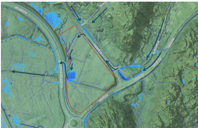
Figur 17. Flödesvägar och översvåmningszoner inom och i anslutning till planområdet med en nederbördsintensitet på 70 mm i Scalgo Live. (Scalgo Live, 2024).
