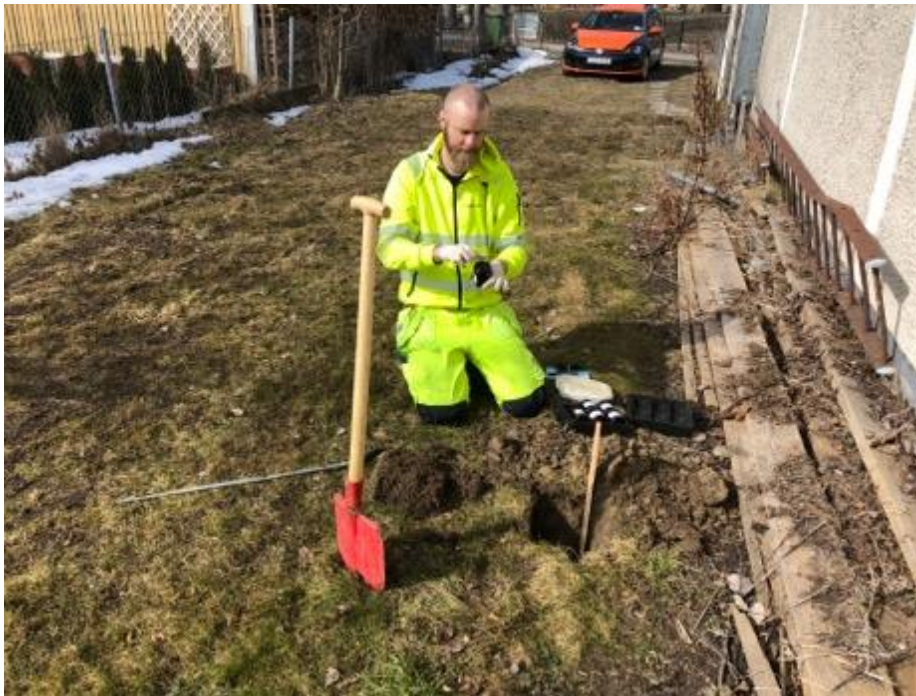
Figur 3. Situationsbild över provtagning av miljötekniska prover för analys av förorenad jord. (Foto: Magnus Hellqvist, Geoveta 2018-04-03.)
