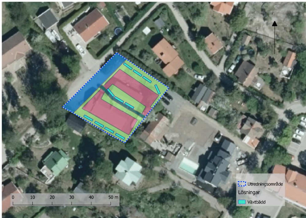
Figur 8:1. Exempel på placering av växtbäddar inom planområdet. Varje enskild växtbädd i illustrationen har arean 5 \text{ m}^2 vilket ger en total area av växtbäddar på 55 \text{ m}^2 i figuren. Detta korresponderar mot arean vilken återfinns i tabell 6:3. (se avsnitt 6.3). Ytorna i figuren ger därmed en fingervisning om ytanspråket avseende växtbäddar kopplat till riktlinjerna om att dagvattenlösningar (växtbäddar) ska anläggas på en yta som motsvarar 6% av total reducerad area.
