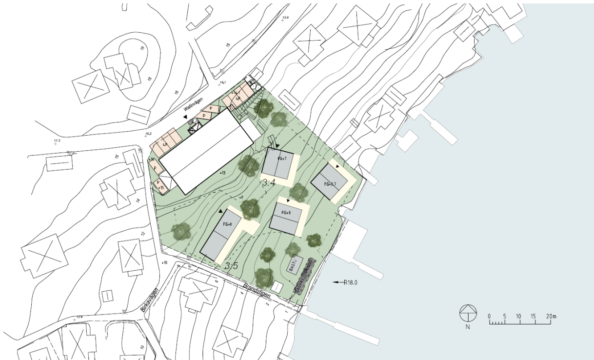
Figur 7. Situationsplan som visar möjlig placering av fyra bostadshus, sjöbod och parkeringsplatser (Sandell Sandberg Arkitekter, 2018).
