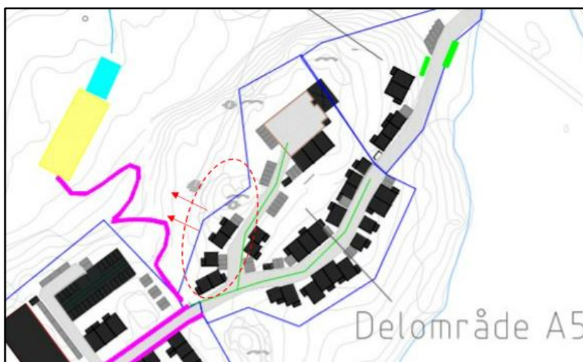
Figur 7:6 Fastigheter inom delområde A5 markerade där det skulle kunna finnas möjligheter att leda vattnet över slänt/grönyta istället.
