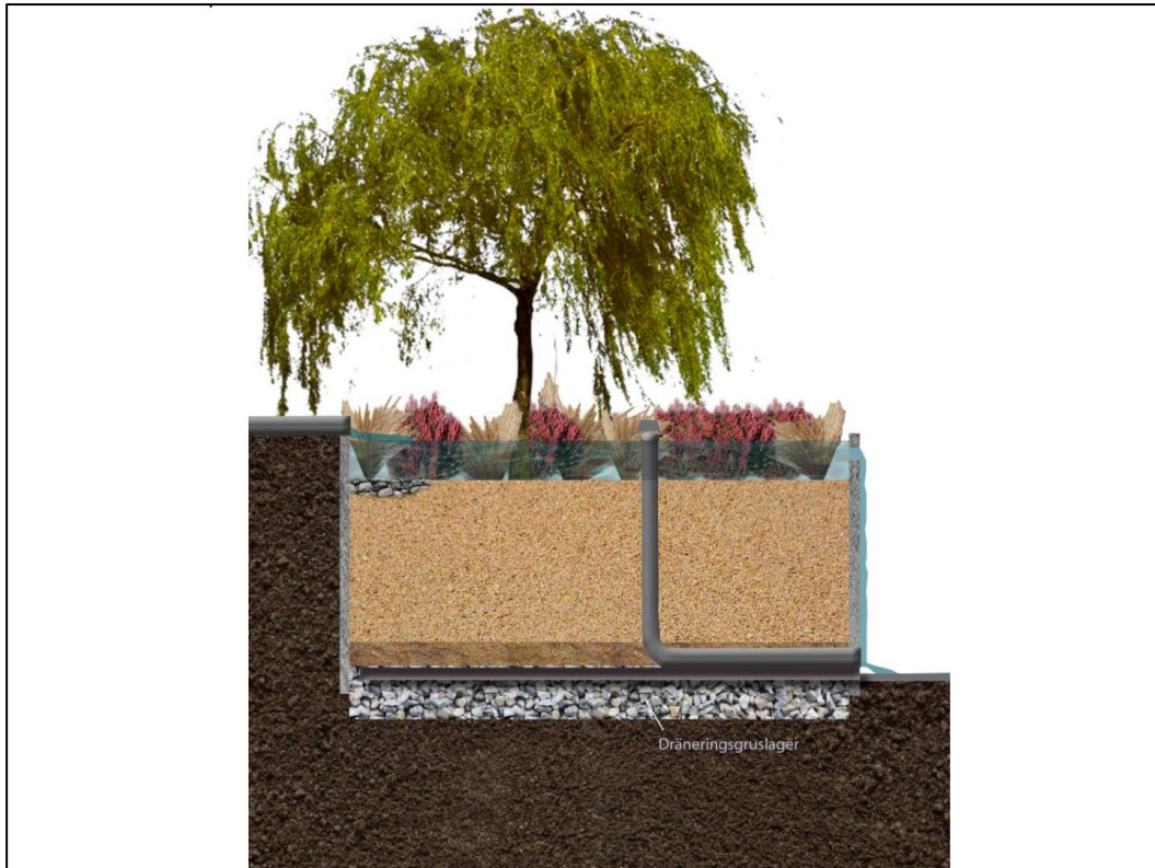
Figur 6-6. Illustration av hur en regnbädd kan byggas upp, där den översvämmade ytan ovanpå växtjorden utgör fördröjningszonen (Illustration Åsa Wellander).
