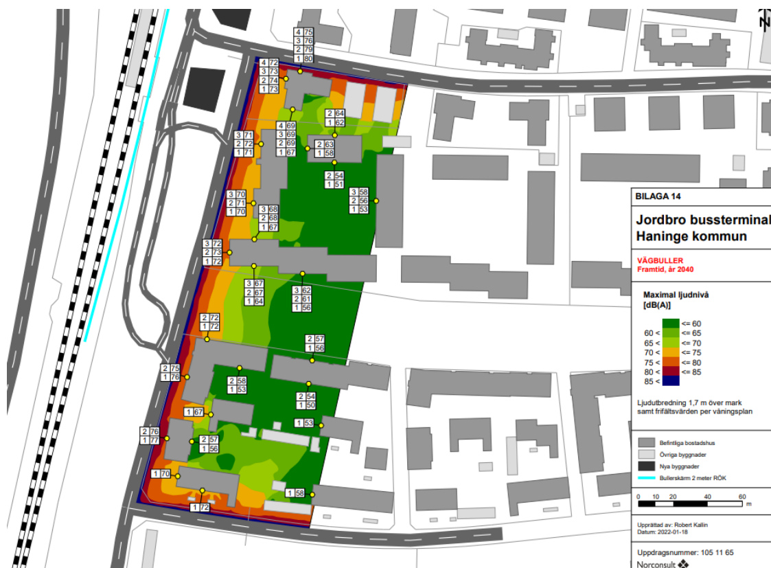
Figur 20. Väg- och järnvägsbuller för befintlig bebyggelse strax intill planområdet och planerad busstation. Norconsult.
