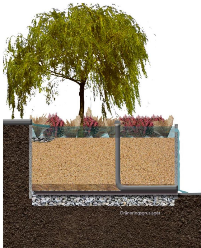
Figur 22. Illustration av hur en regnbädd kan byggas upp (Åsa Wellander i Geosigma, 2019).
