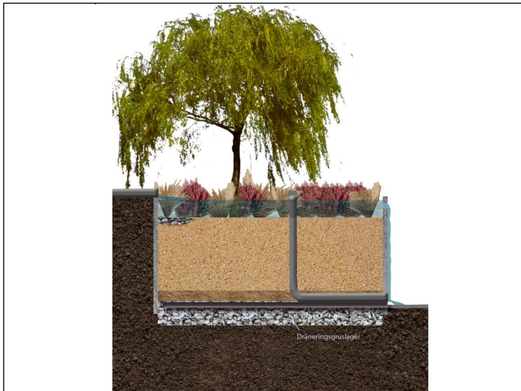
Figur 6:8. Illustration av hur en regnbädd kan byggas upp, där den översvämmade ytan ovanpå växtjorden utgör fördröjningszonen (Illustration Åsa Wellander).
