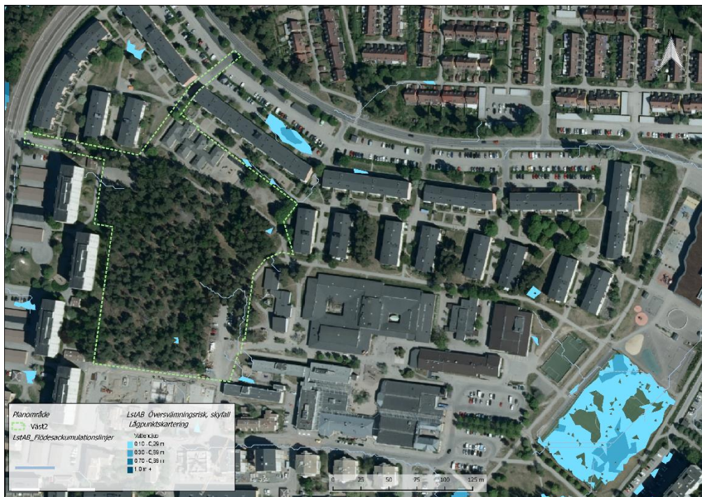
Figur 6:1 Områden som riskerar att översvämmas i det västra området vid skyfall enligt Länsstyrelsens kartering.
