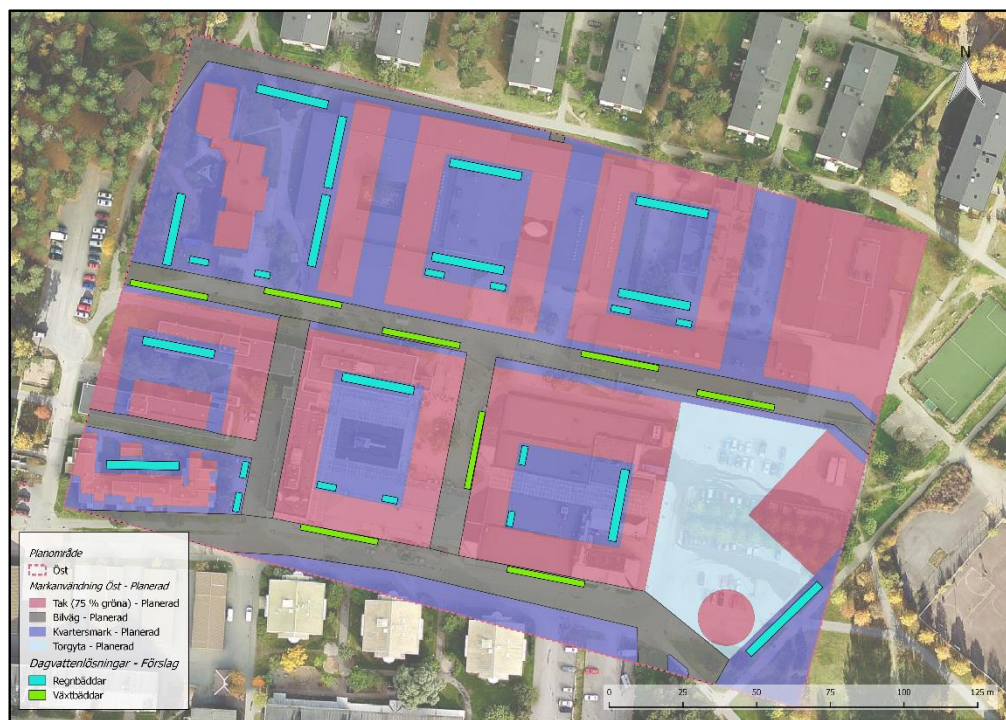
Figur 7:1. Exempel på placering av växtbäddar med skelettjord och regnbäddar för fördröjning av dagvatten i det östra området.
