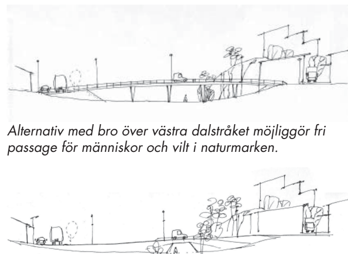
Alternativ med vägbank med vägport över västra dalstråket. Porten görs bred och slanterna flackas ut vid mynningen.
