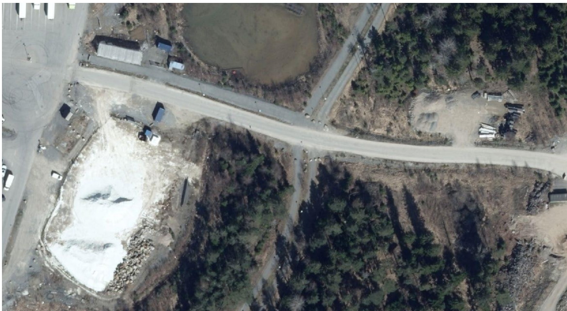
Figur 18. Befintlig koppling mellan etapp 1 och 2. Stenar har placerats där Albybergsringen korsar gång-, cykel- och ridvägen för att uppmärksamma och hindra cyklister från att köra ut i körbanan i hög hastighet.
