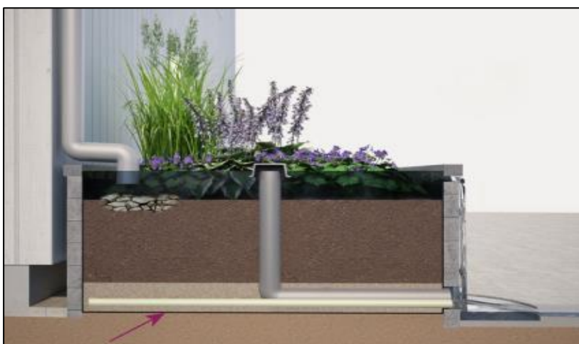
Figur 24. Principskiss över en växtbädds funktion i profil. Växtbädd "typ 4" med tät duk. Används lämpligen för att undvika perkolations. Bildkälla: Movium 2, 2015, illustration: Tengbomgruppen.
