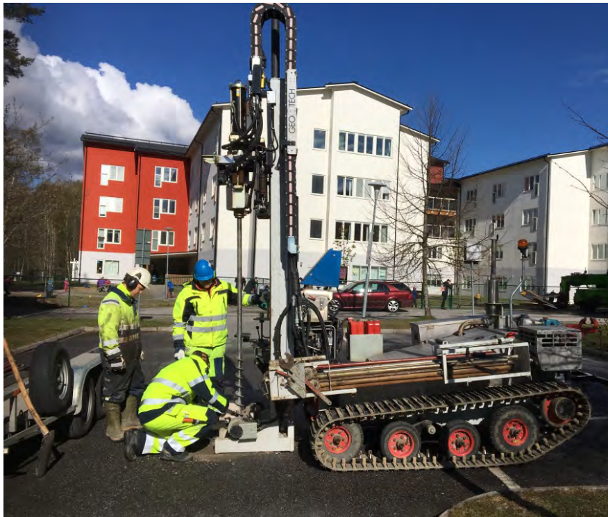
Figur 5. Söderbymalm. Skruvborrning för jordartsbedömning och provtagning i borrhunkt 1.
