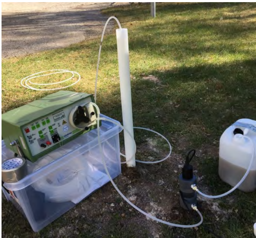
Figur 5. Omsättning av grundvatten med en elektrisk peristaltisk sugpump med en flödescell påkopplad för att mäta vattenparametrar.
