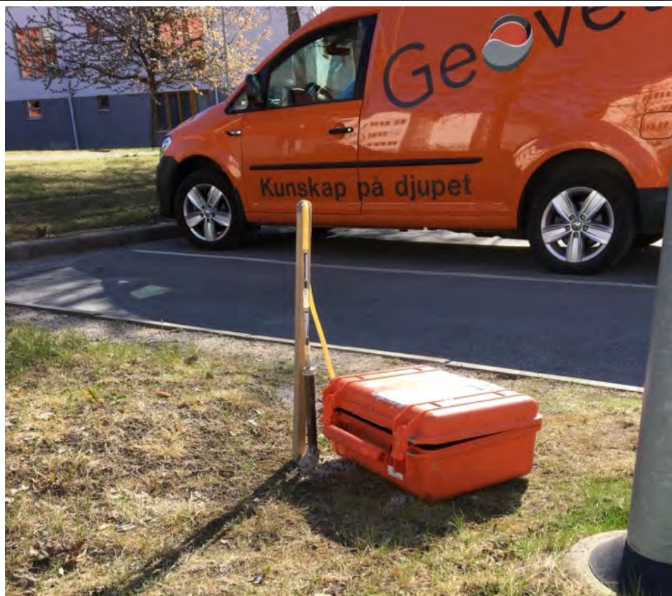
Figur 4. Aktiv provtagning av porgas vid BP01.
