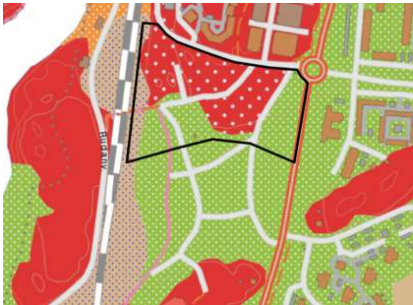
Figur 7. Jordarter i området. Grönt - isälvssediment, sand; rött - berg; rött med vita prickar - berg med tunt eller osammanhängande lager med morän; beige med blå prickar - kärrtorv. (Utdrag ur SGU:s jordartskarta på www.sgu.se )
