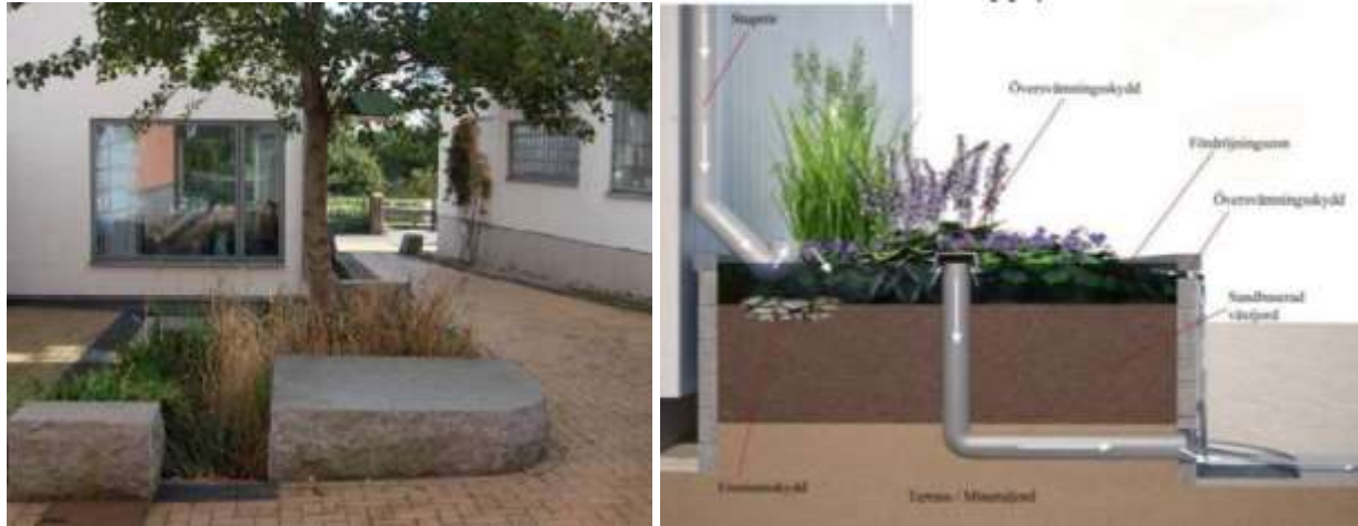
Figur 22. Exempel på hur växtbädd eller regnträdgård kan utformas och konstrueras.
