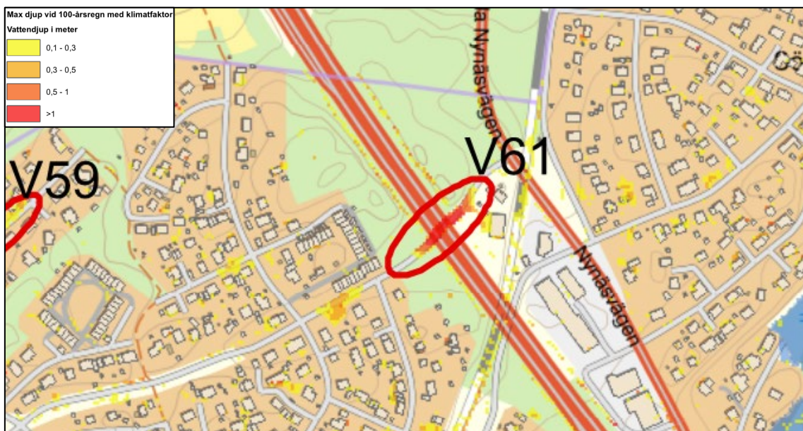
Figur 8 Enligt skyfallskarteringen samlas vatten med stort vattendjup där Nordenskiöldsväg passerar under riksväg 73 markerat med röd ellips och benämning V61.
