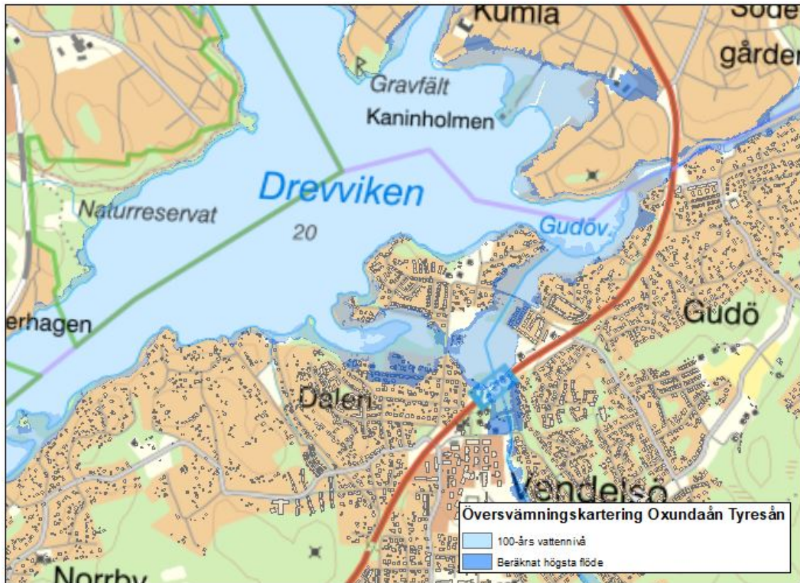
Figur 22. MSB:s översvämningskartering i område runt Drevviken. Fördjupade utredningar efter att denna kartering togs fram har visat att Drevvikens utlopp var felbeskrivet i MSB:s kartering och att översvämningsnivåerna därför är överskattade i figuren.
