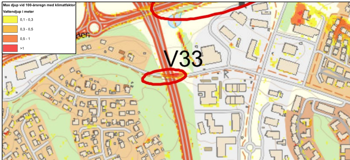
Figur 9 Enligt skyfallskarteringen samlas vatten med stort vattendjup (>1 meter) där Vendelsövägen passerar under väg 73 markerat med röd ellips och benämning V33.
