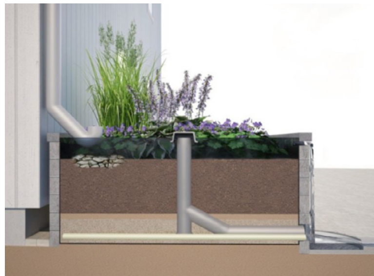
Bild 10: Principskiss av regnbädd under marknivå med dräneringsrör och bräddning till dike. Bräddning kan även ske till intilliggande gräsplan eller naturmark där det finns goda infiltrationsmöjligheter (vänster). Källa: Norconsult. Exempel på en så kallad nedsänkt regnbädd över marknivå, där nedsänkningen under kanten skapar en fördröjningsvolym (höger). Illustration Kent Fridell och Kristian Klasson, Tengbomgruppen AB.
