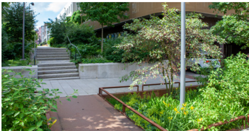
Infiltration och gröstruktur i staden – biokolsbäddar tar emot gatuavatten, renar och bidrar med goda tillväxtförhållanden till grönska. Norra Djurgårdsstaden, Stockholm.
