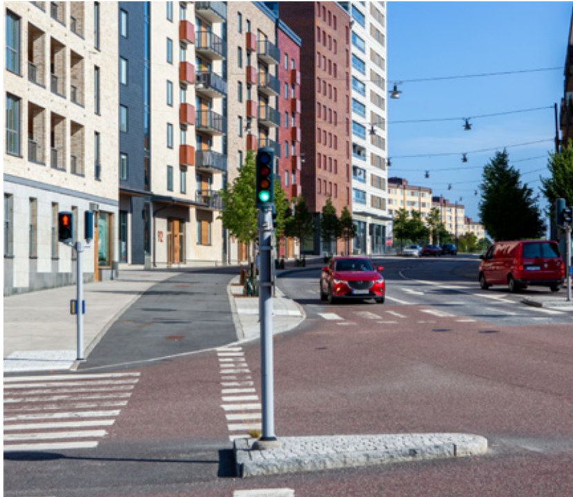
Huvudgata med två körfält i ena riktningen, varav ett är för högersvängande trafik intill signal-reglerad korsning. Nynäsvägen, Handen.
