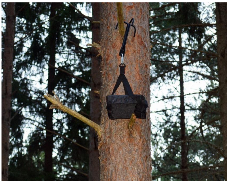
Figur 2. Autoboxar hängdes upp i träden på ca 3 meters höjd och registrerade fladdermusljud under hela natten.
