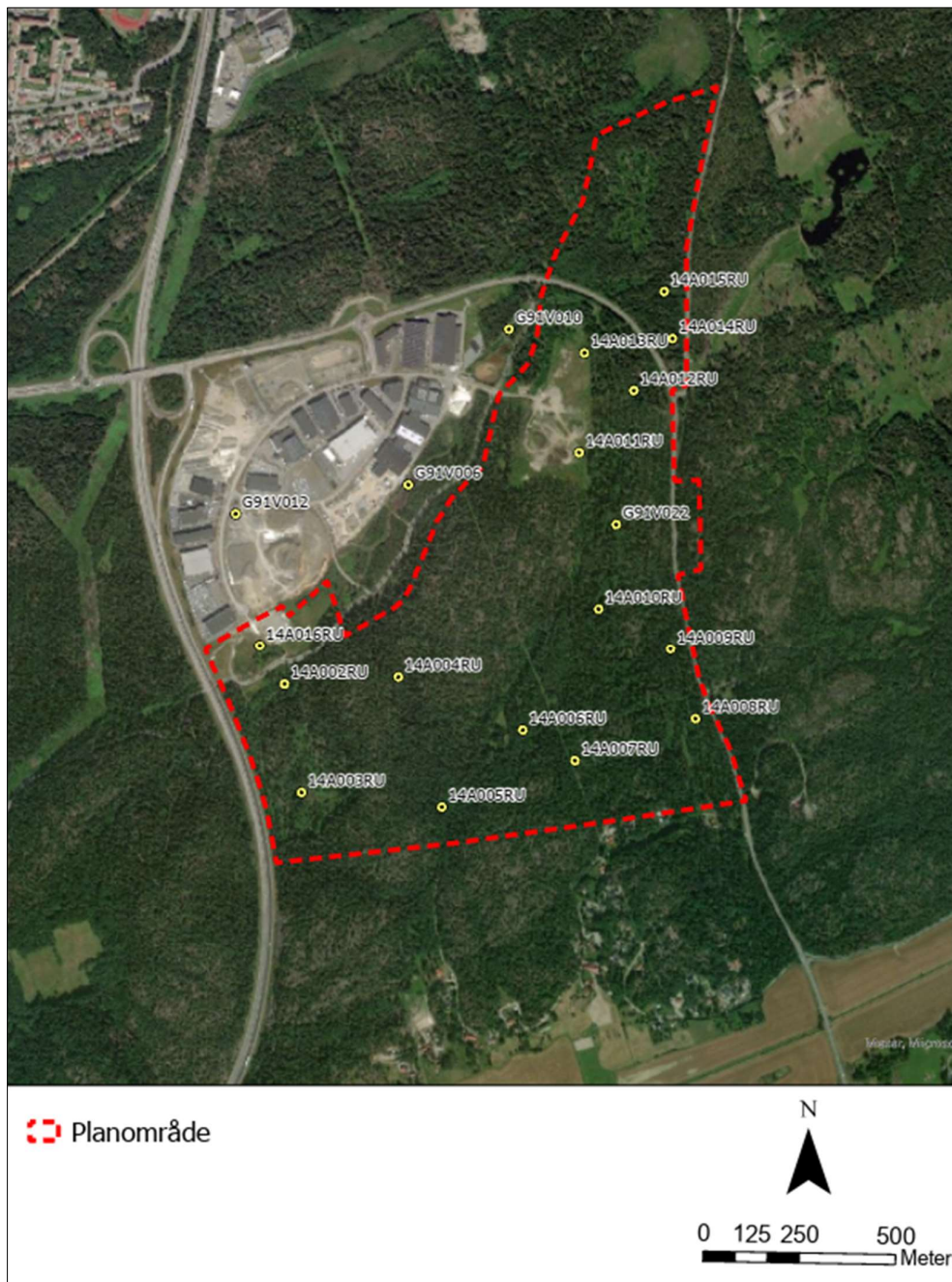
Figur 5.2 Installerade grundvattenrör i området.
