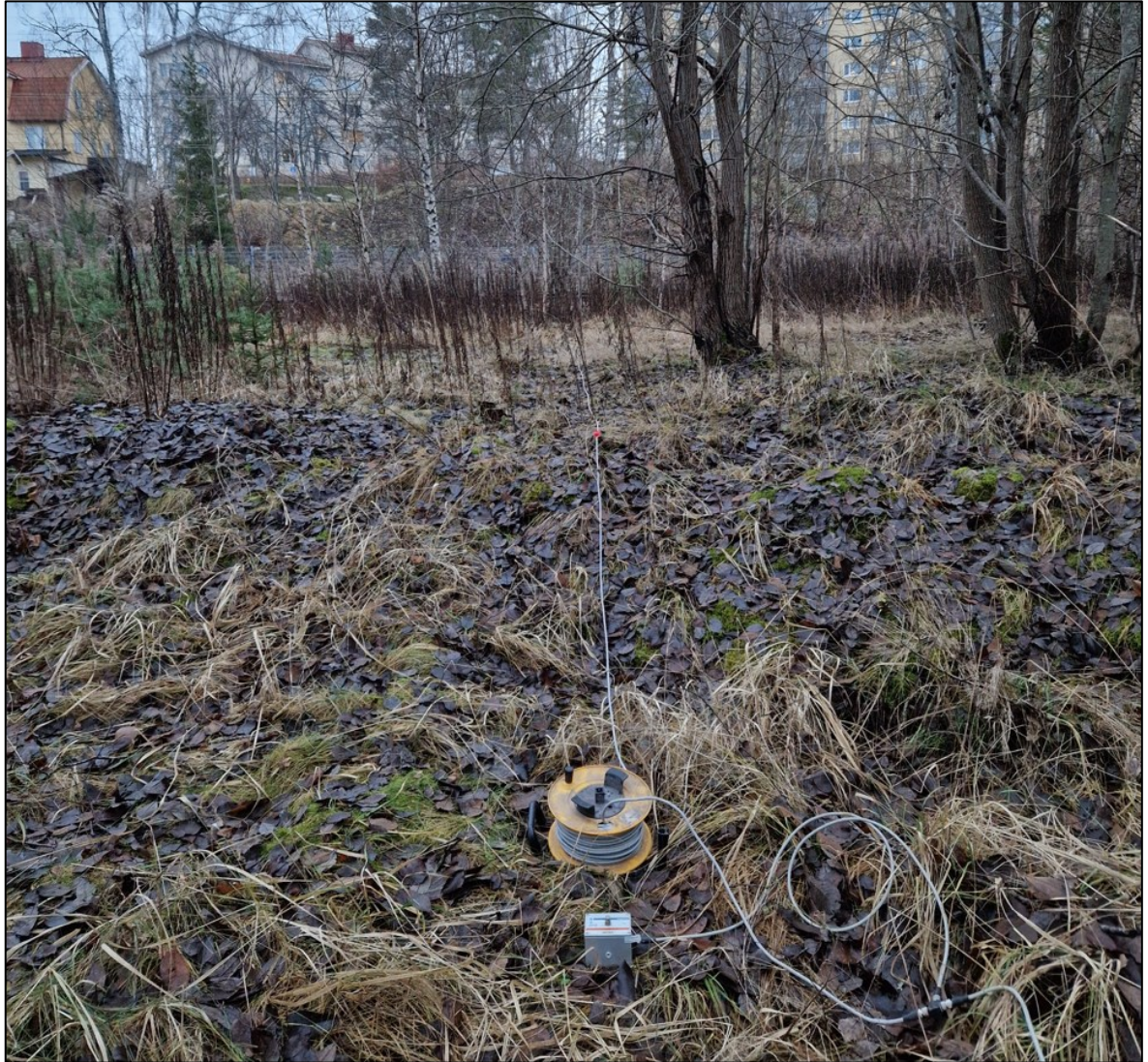
Figur 7. Mät punkt 7, monterad på markspett.
