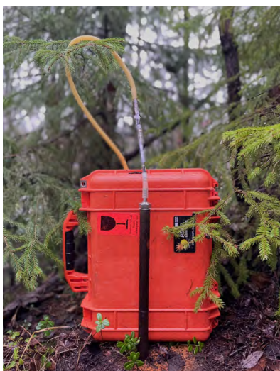
Figur 4. Porgasspjut med suggpump i väska där porluften suggs upp genom spjutet till kolfilterrör inne i väskan.
