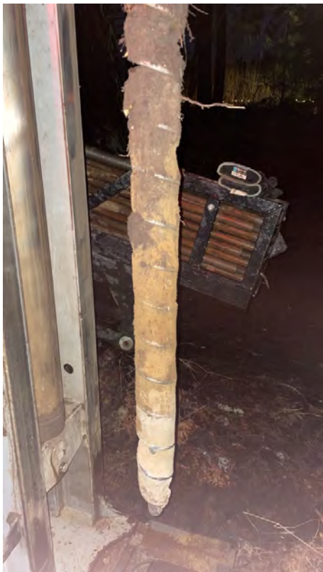
Figur 3. Skruvprov från punkt 25GTMP01. Tre tydliga jordlager visas i figuren. Översta lager av organiskt material, ett mellanskikt av ljus sand samt ett underliggande lager av grus.
