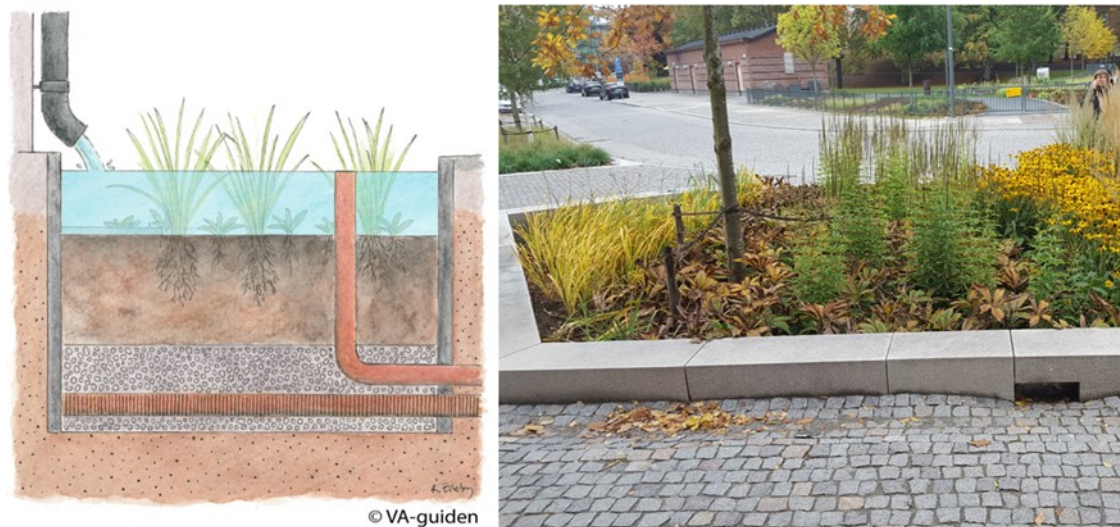
Figur 19. T.v. principskiss (källa: VA-guiden, u.å.) och t.h. exempelbild av nedsänkta växtbäddar.
