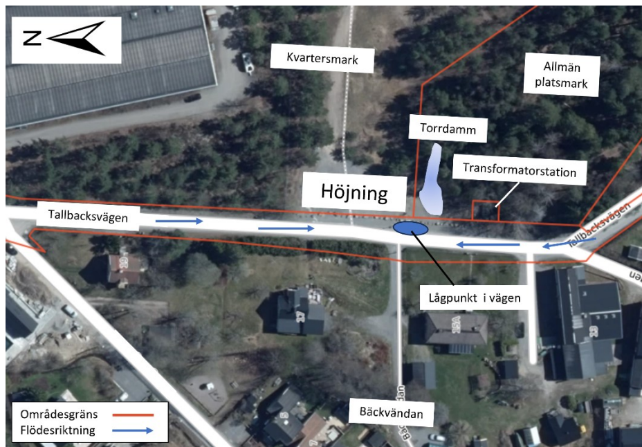
Figur 30. Föreslagen placering av torrdamm för fördröjning av skyfallsvolym från Tallbacksvägen. Röda linjer visar uppdelning mellan kvartersmark och allmän platsmark.
