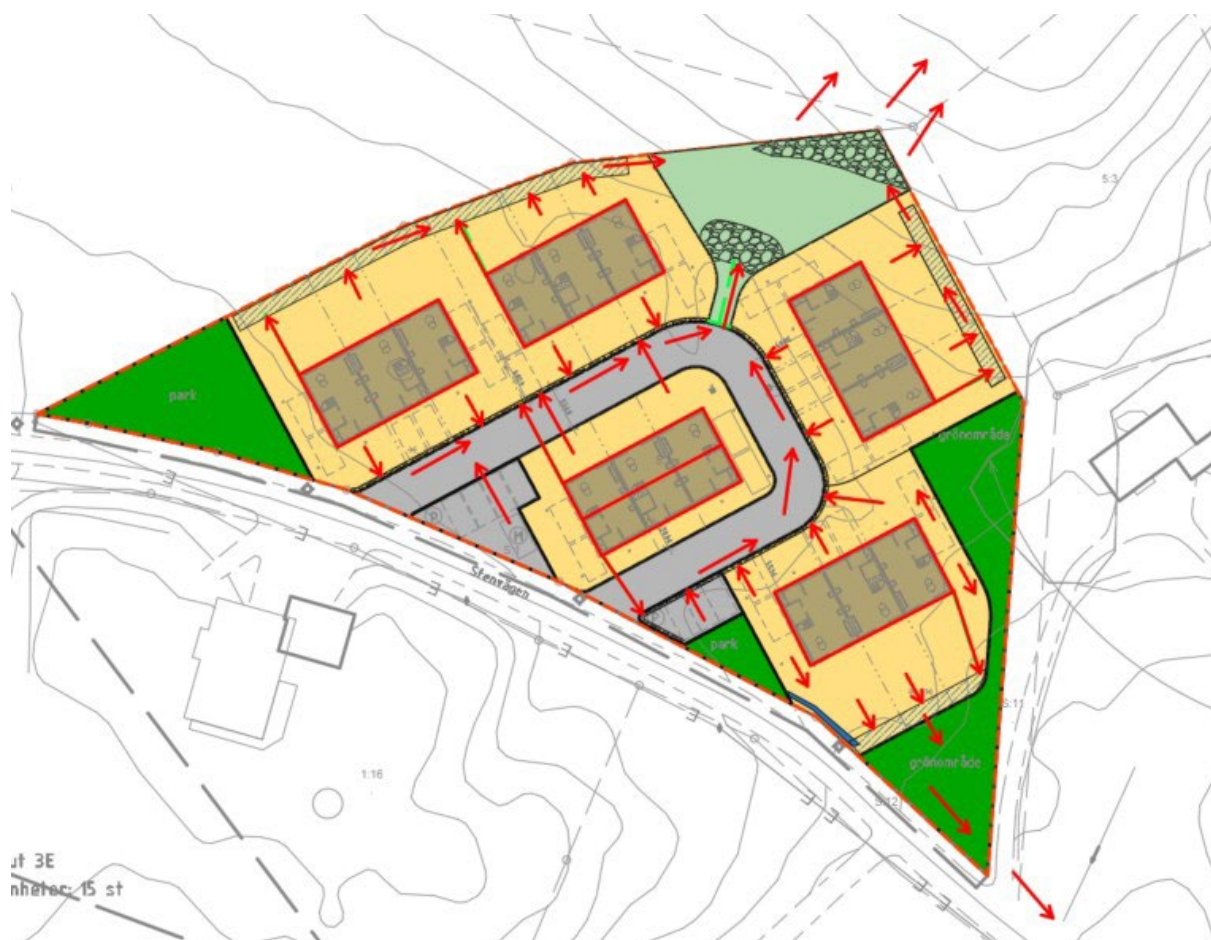
Figur 5. Avrinningsvägar med föreslagna dagvattenlösningar. Bild: Novaterra
