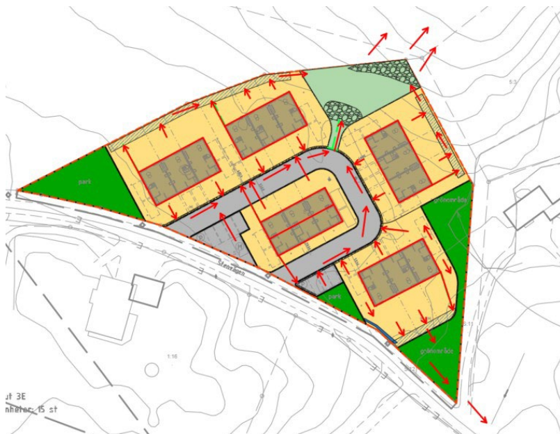
Figur 5. Avrinningsvägar med föreslagna dagvattenlösningar. Bild: Novaterra
